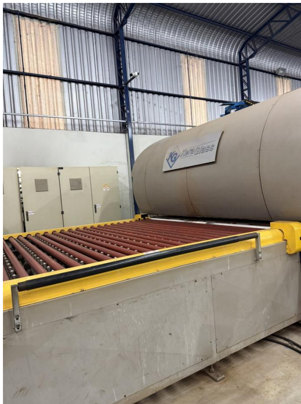
Fotografia 22 — Forno de têmpera de vidro (KeraGlass)
