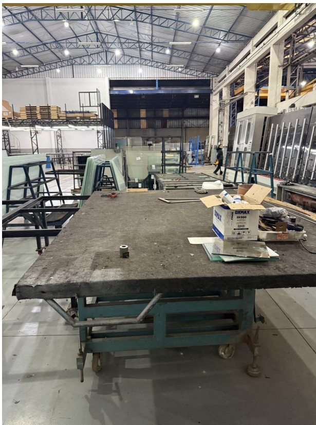
Fotografia 06 — Linha de produção — montagem de vidro insulado e emprego de selante estrutural
