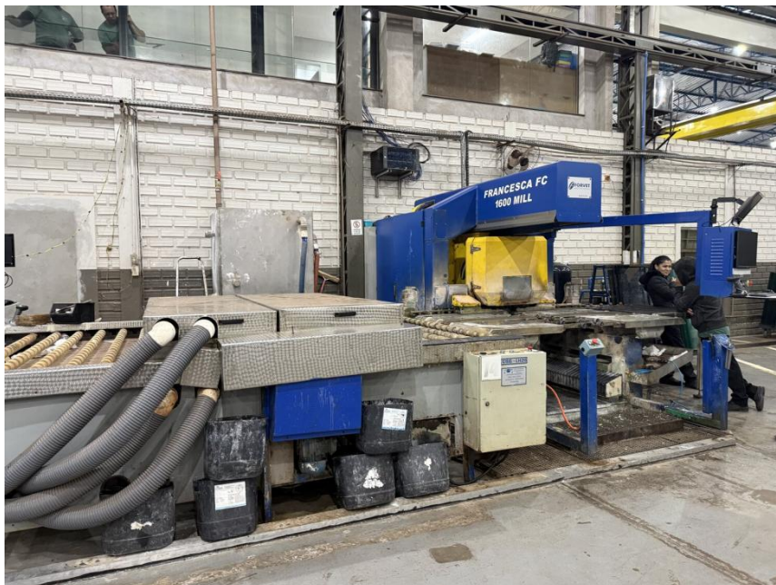
Fotografia 23 — Centro de usinagem/lapidação de vidro CNC (Francesca FC 1600 — FORVET, Itália)
