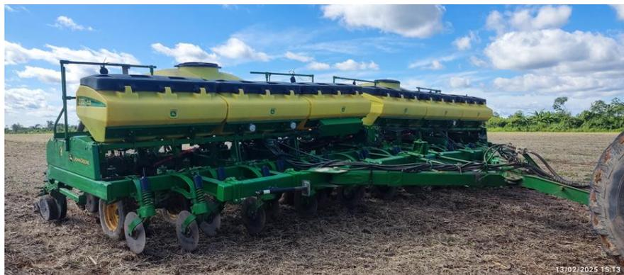
Acoplada a tratores e utilizada na plantação das sementes, tornando o plantio eficiente, substituindo o trabalho manual e aumentando a produtividade e eficiência do plantio.
