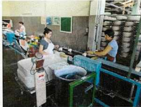
Figura 18 – Linha de Vidragem por Emerssão em Verniz.
