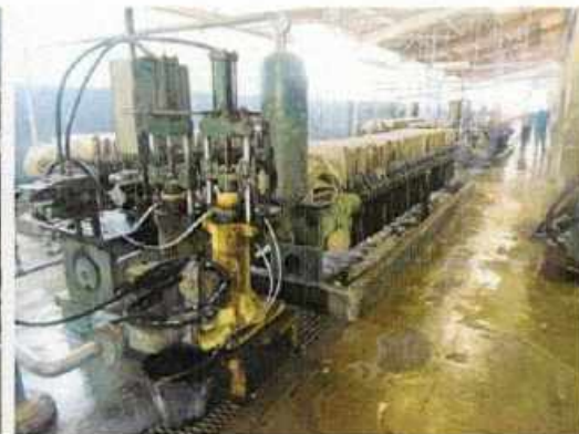
Figura 6 – Prensa para secagem.
