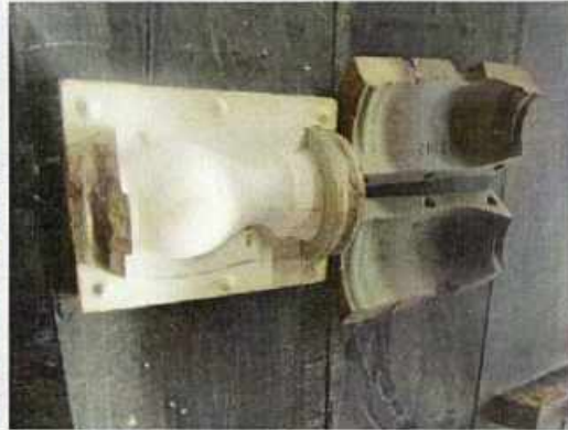
Molde de vaso de arodite epóxi
