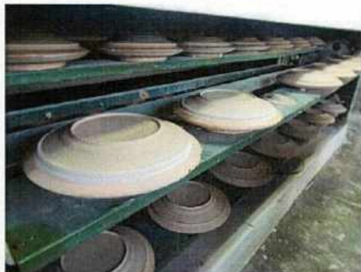
Figura 14 – Pratos são colocados nos secadores.
