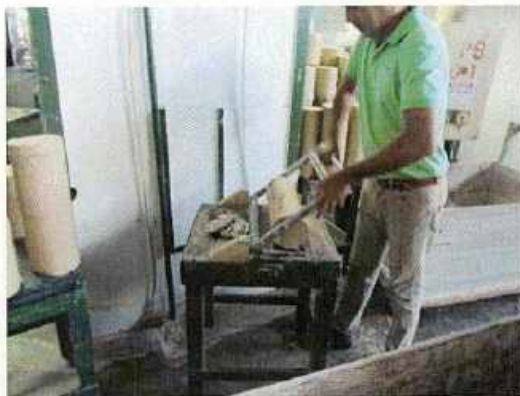
Figura 11 – Corte dos Tarugos de massa.
