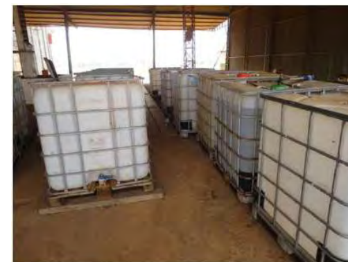
Tanques de arla para abastecer caminhões da Seara
